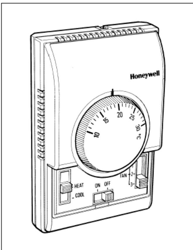
Термостаты T6370 и T6371 разработаны для управления клапанами или клапанами и вентиляторами в системах 2 -х трубных фэн-койлов. Термостат производит on/off регулирование клапана для обеспечения достижения и поддержания заданной уставкой температуры.
